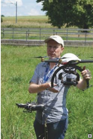
So schaut ein ferngesteuerter Quadrocopter mit vier Rotoren zum Auffinden von Rehkitzen aus. © Goetz
